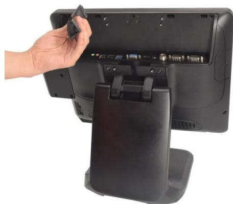
3. Привинчиваем кабель дисплея покупателя VFD 2\*20
