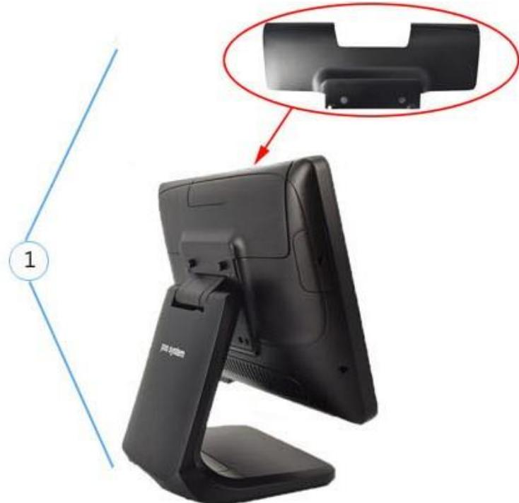
2. Снимаем металлическую пластину
